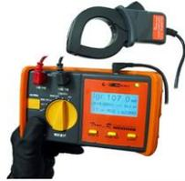
・Igr漏電測定記憶装置 (探査器)
